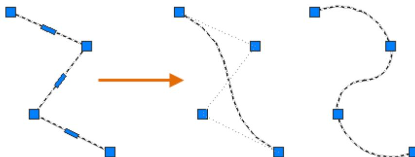
Nota: Se puede convertir una polilínea de ajuste de spline en una B-spline con el comando Spline, opción Objeto.
